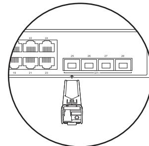
光模块分别插入交换机的SFP+插槽
